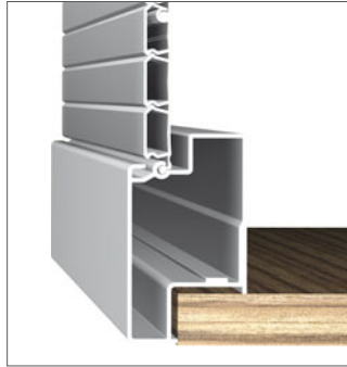
Klassische Korpuskonstruktion mit überlappender Griffleiste
